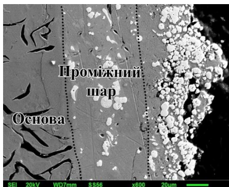
Рисунок 5.52 – Мікроструктура покриття «50 % WC + 50% Al-бронзи»
