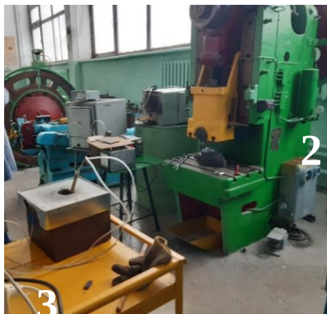
Рисунок 4.76 – Устаткування для проведення ТМО: а – піч для аустенізації (1), б – гідравлічний прес (2) та ванна ПОС-61 (3)
